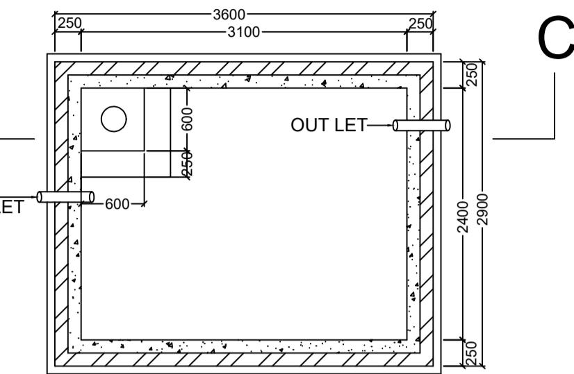
**DETAILS OF SEMI-UNDER GROUND WATER RESERVOIR**
